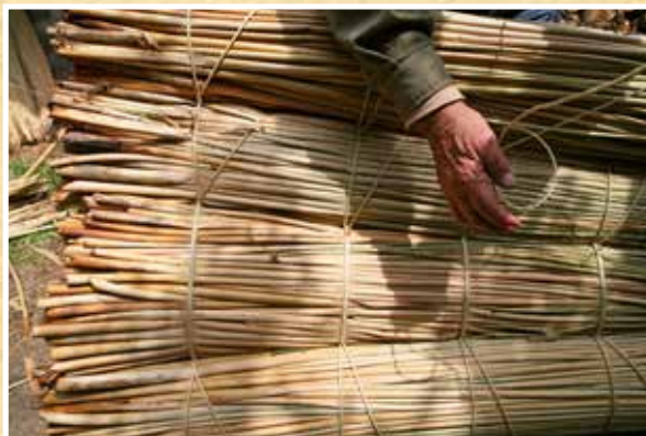
Su fassoneri. I pescatori erano soliti utilizzare “su fassoni” quale imbarcazione da pesca nelle lagune dell’oristanese; leggero ma solido e agile, era il frutto di una lavorazione sapiente, dalla raccolta ed essiccazione del giunco al suo assemblaggio.
